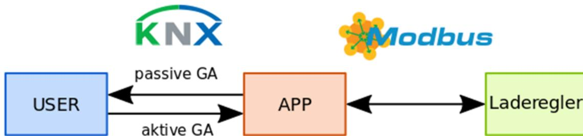
Da der Verbindungsaufbau über Modbus TCP gegenüber der reinen Datenübertragung eine signifikante Zeit beansprucht, liest die P-Charge APP das komplette Speicherabbild des Ladereglers auf Wunsch oder nach einstellbarer Zeitspanne aus und versendet die gewünschten Informationen auf parametrierbare KNX-Gruppenadressen. Sollen beschreibbare Register per KNX verändert werden, wird dies sofort ausgeführt.
