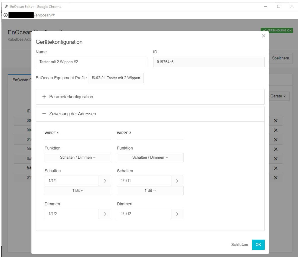
Abbildung 4: Beispiel Gerätekonfiguration im EnOcean-Editor des APP MODULE
